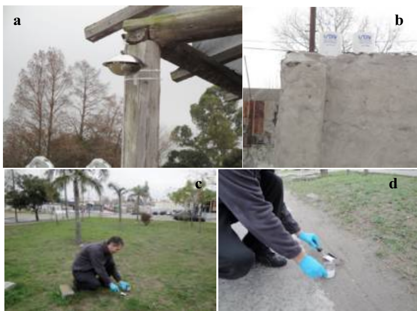
Figura 4. Despliegue de muestreadores pasivos de aire(a), colectores de partículas (b), muestreo de suelo (c) y de sedimento vial (d).
